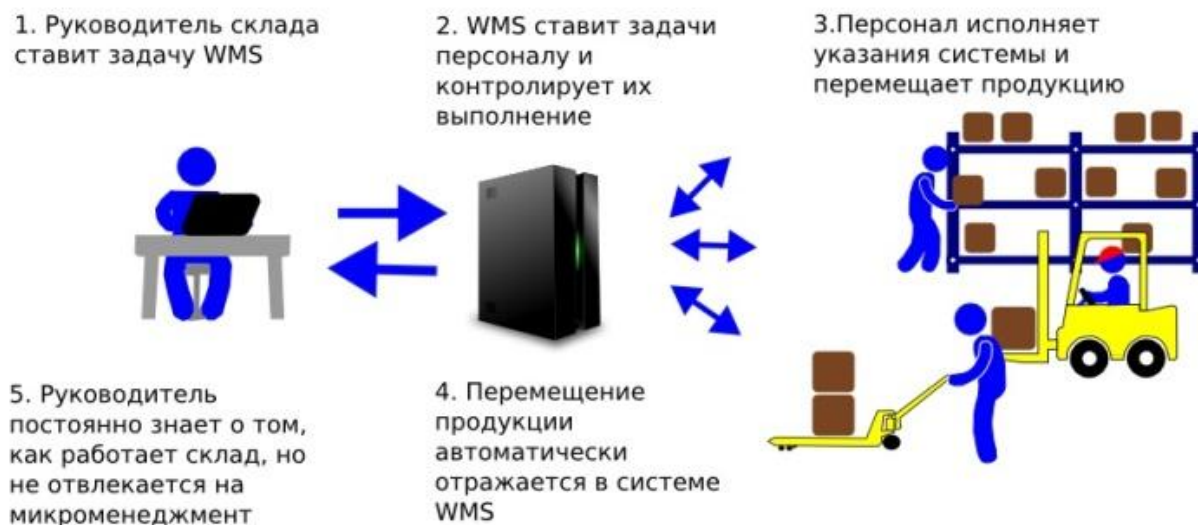
Рис. 1 – наглядная схема работы системы управления складом
