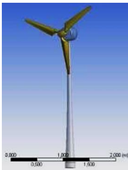
Рис. 1 – Геометрия модели однороторной ВЭУ в ANSY DesignModeler
